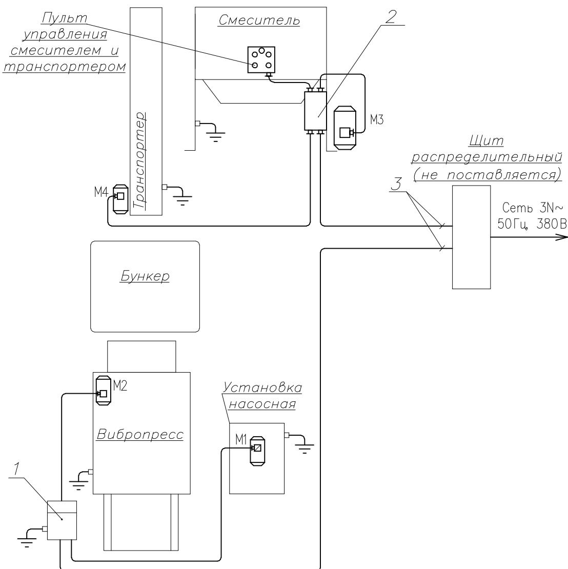
Рис. 16. Схема электрическая подключения.
