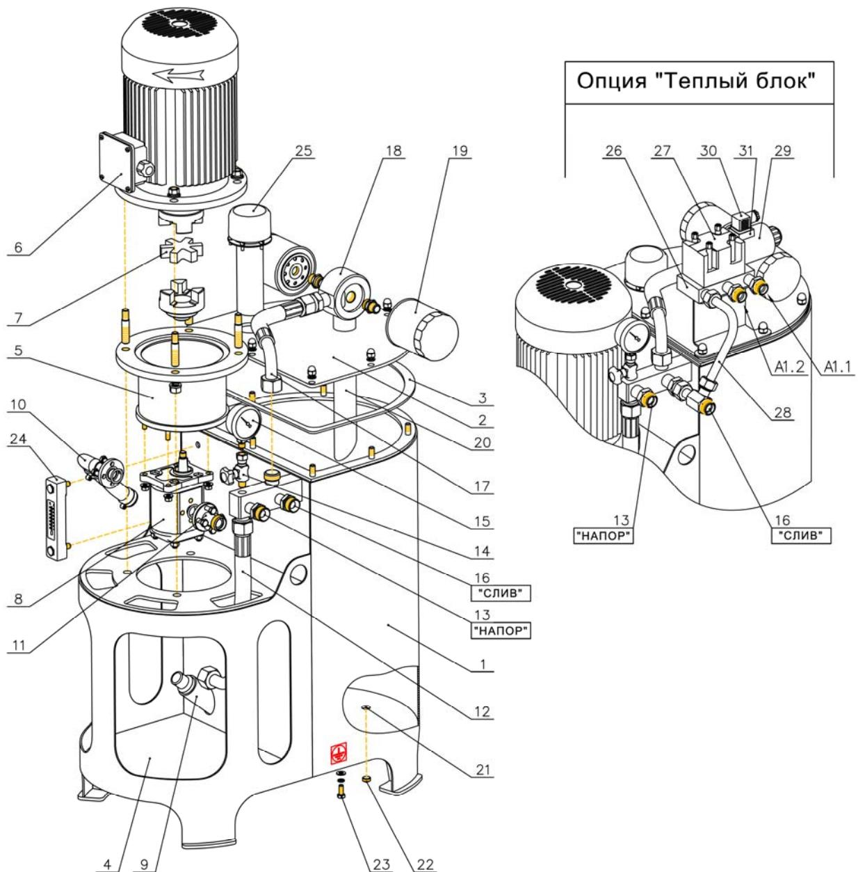
Рис. 5. Установка насосная.
