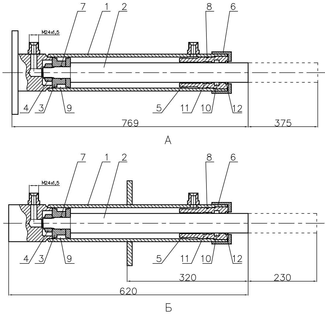
Рис. 7. Гидроцилиндры.
