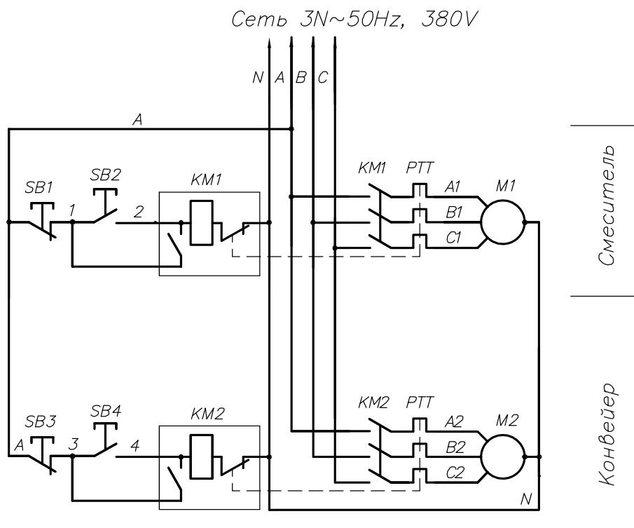
Рисунок 15. Схема электрическая принципиальная.
