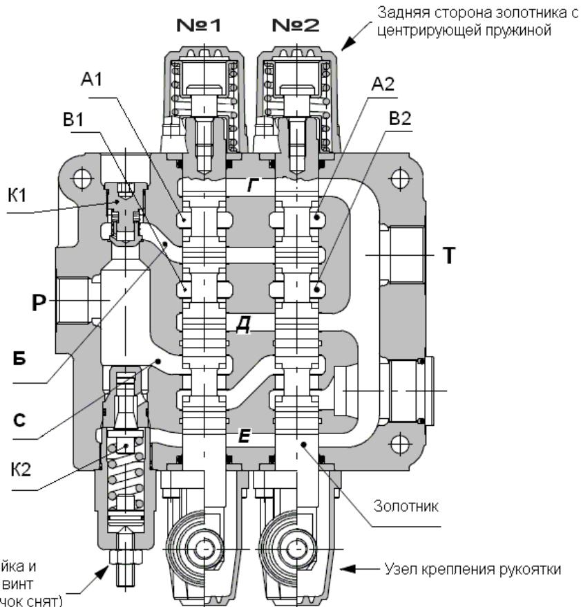
Рис. 6. Гидрораспределитель AMI R252
