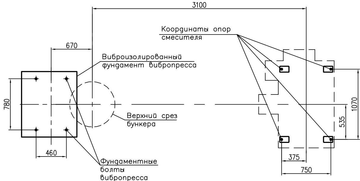
Рис. 17. Схема установки вибропресса, бункера и смесителя.
